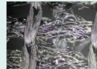
エフコット®の複雑な繊維の形状である独自のクリンプ(縮み)が、フィルター機能をするにより、花粉やホコリが引っかかることで空気中の浮遊量を低減します。
